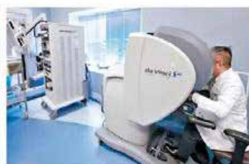
●機械人輔助手術系統配備如荧光影像視覺系統、融合3D模型、術中超聲波影像掃描等，提升手術精準度。
