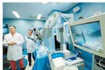
●機械人輔助手術系統中的機械手臂，可多軸向運動，模仿人體手腕轉動和抓握動作，操作靈巧，較傳統微創手術更為精準。
